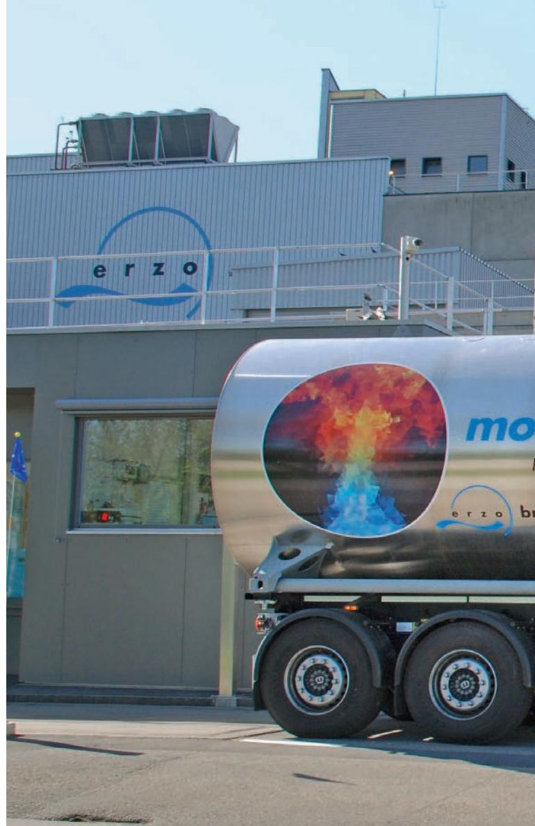
100 Grad Celsius auf. Dabei verflüssigt sie sich. Mit einer effektiven Wärmedämmung des Containers behält das Salz die Temperatur bei, während es per LKW zum Verbraucher gelangt. Dieser kann die thermische Energie mit einer Leistung von 300 kW wieder ableiten. Die Entnahme von Wärme bis zu einer Temperatur von 40 Grad ist möglich.
